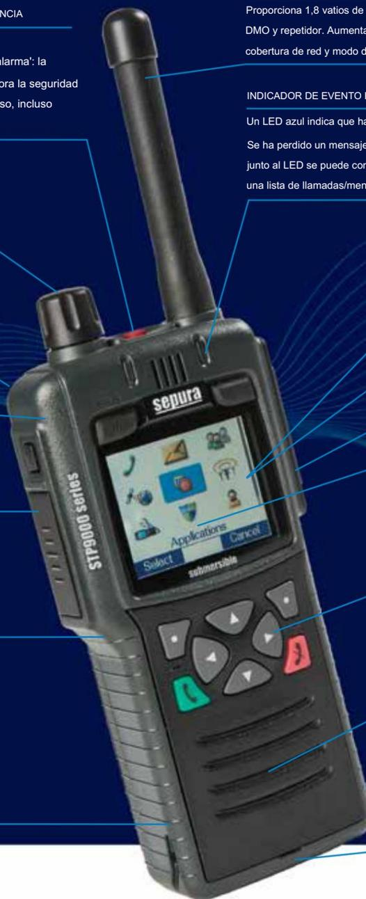
**Robustez:** El STP9100 cuenta con una clasificación de protección ambiental IP67, resistente al agua y al polvo, lo que significa que seguirá funcionando incluso después de sumergirse hasta 1 m de agua durante 30 minutos. Además, la nueva tecnología Connector Protector proporciona protección marina contra los daños corrosivos que el agua salada y la niebla salina pueden causar en las superficies expuestas.
