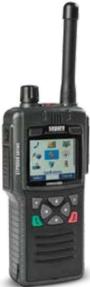
El STP9100, un dispositivo portátil, combina una robustez extrema con un audio y una radiofrecuencia potentes. Resistente al agua y sumergible. Resistente al polvo y reforzado para uso marino, el STP9100 con clasificación IP67 proporciona la última tecnología inteligente a los usuarios que necesitan una radio confiable y de alta especificación, pero prefieren una interfaz de usuario optimizada.
